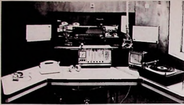
Aanzicht van de eindpresentatiestudio van ECK 2. In het midden een schakelpaneel, waarop de omroeper met de verschillende technische ruimten kan communiceren en verschillende programma's kan beluisteren. Links een grammofoon om buiten de uitzending om bepaalde platen bestemd voor de uitzending te kunnen beluisteren. Ook hier een hoogwaardige af luistering op luidsprekers. De studio is in zijn geheel speciaal trillingsvrij in het gebouw gefundeed.
